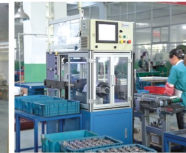
▲ 全自动圆锥轴承游隙检测机 Taper Roller Bearing Automatic Clearance Check Machine
